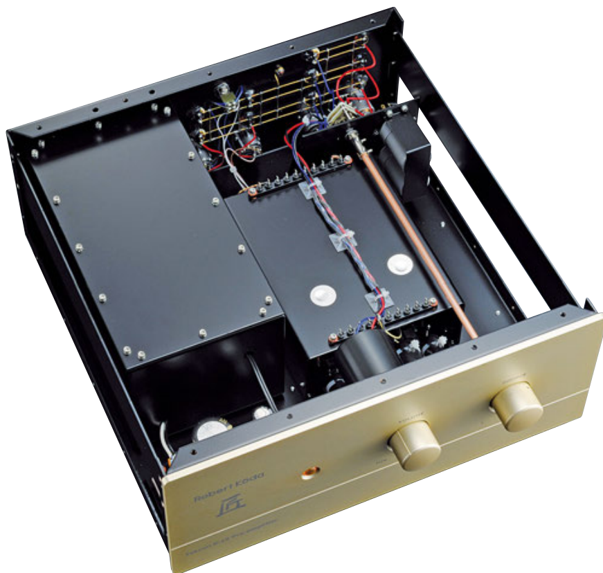
La costruzione interna ricorda più una cassaforte che un apparecchio audio. Tutte le sezioni circuitali sono blindate e celate alla vista. L'alimentazione in particolare è assolutamente inespugnabile.
