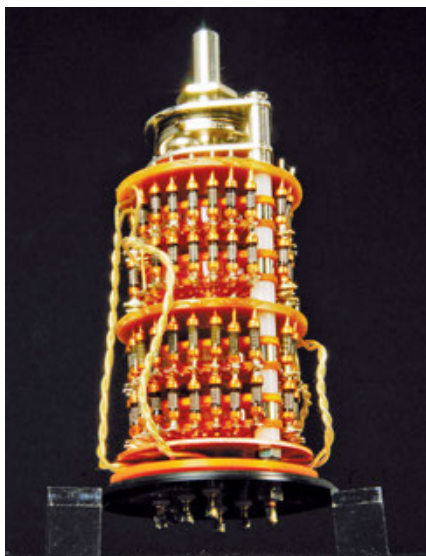
Il controllo di volume, dalla costruzione particolarmente accurata, è del tipo a resistenze, di cui mai più di due vengono a trovarsi sul percorso del segnale.
