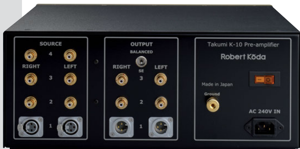
Il pannello posteriore, abbastanza spartano, offre da sinistra a destra tre ingressi linea e uno bilanciato, due uscite linea e una XLR e, infine, sulla destra, il pulsante di accensione del tipo retroilluminato (rimane però comunque spento, demandando alla spia sul frontale l'informazione di avvenuta accensione), la vaschetta IEC e un morsetto di connessione a terra.
